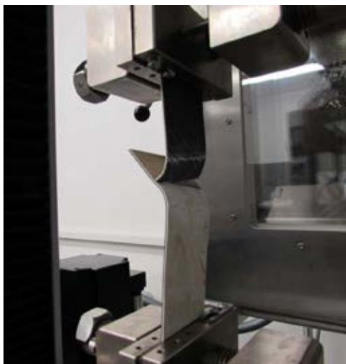
Obr. 7 – Odlúpnutie v spoji (nevyhovujúci výsledok)
